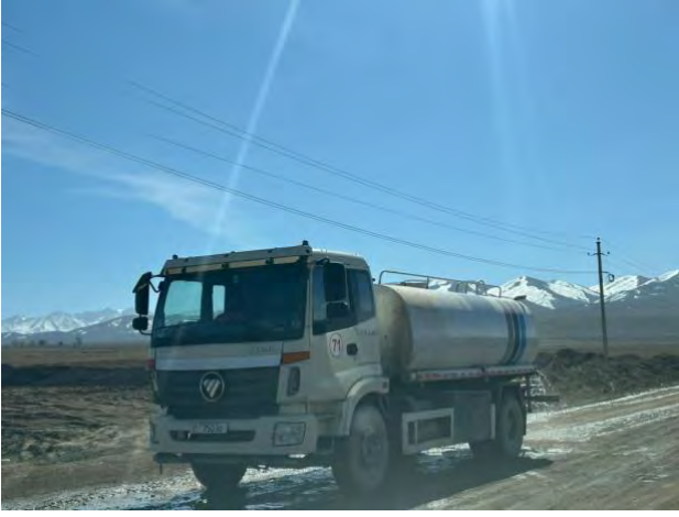
Фото 49. гидроорошение подъездной дороги к карьеру на км 194.
