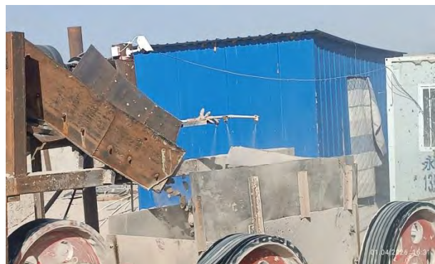
Фото 2. Система гидроорошения на ПГУ установлена в приемном бункере, а также на конвейерных линиях.
