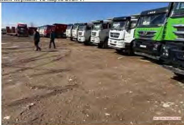
Фото 19. Лагерь в с.Чырак, км 200+000. Отсутствие твердого основания парковки.
