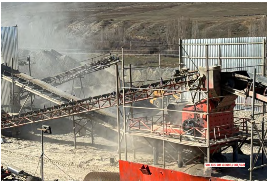
Рисунок 11: Производственная база, км.202+220 п.с., пылевыделение при работе ДСУ
